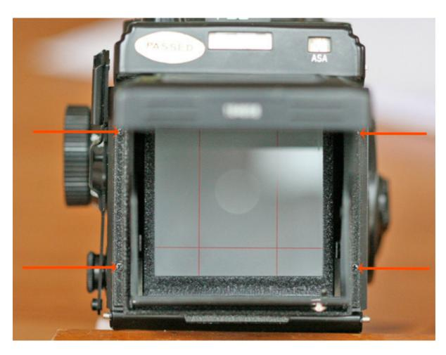
Damit bei der Reinigung kein altes Material in die Kamera fällt möchte ich Ihnen empfehlen die Kamera auf die Frontseite auf ein Tuch legen. Wie hier auf dem Bild gut zu sehen ist haftet nur noch die erste Klebeschicht der alten Dichtung, hier können Sie mit einem flachen Schraubendreher an einer Kante das Material anheben und dann komplett mit der Pinzette abziehen.
