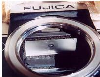
Esquerda: Fujica ST605n. O amortecedor está em toda a volta do vidro de focagem. Conselho: a substituição da almofada do amortecedor frontal é normalmente suficiente.
