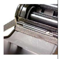
Geralmente uma tira de vedante ao corpo ou porta da máquina, ou ambas. **IMPORTANTE**: Se colocar um vedante novo no lugar errado, humedeça-o com solvente\* e espere 1 minuto. O solvente irá soltar o vedante permitindo a sua reposição enquanto húmido. Após secar poderá ser novamente fixado. NÃO USE SOLVENTE NO AMORTECEDOR DO ESPELHO. <u>Imagens na última página</u> mostram este procedimento.
