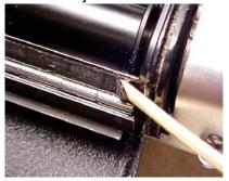
Amortecedor de espelho substituído numa Ricoh
