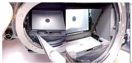
Gauche: la mousse d'amortissement d'un Olympus OM-1. Il s'agit d'une pièce de mousse de 1.5mm en forme de "L". Je l'enlève avec précaution. Milieu: Vous voyez que j'ai découpe deux morceaux en "L" en remplacement que j'ai positionné avant de les presser.
