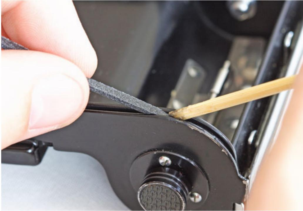
**Wenn Sie den Kameradeckel schließen bemerken Sie einen Widerstand, dies ist normal da sich das neue Dichtungsmaterial erst einmal an den Deckel anpassen muss. Nach ca. 4 bis 8 Stunden hat sich dieser Widerstand normalisiert.**
