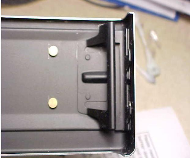
Einige Leute wollen die haftende Seite der Dichtung auf die zwei Vorsprünge setzen. Tun Sie das nicht, die Dichtung arbeitet sonst nicht richtig. An dem linken Bild ist gut zu erkennen, dass zwischen den beiden Flanschen ein ca. 1 mm breites Verbindungsstück ist. Setzen Sie die Dichtung auf alle drei Positionen, also erster Flansch, Verbindungsstück und zweiter Flansch. Nur so hat die Dichtung auch den richtigen Halt und wird auch nur dann richtig funktionieren.
