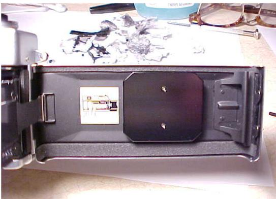
Ihre neue Dichtung sollte jetzt wie auf dem linken Bild sauber und ordentlich ausschauen. Setzen Sie die Druckplatte ein. Die Schritte die Sie zum entfernen gemacht haben einfach rückwärts wiederholen. Betrachten Sie jetzt die Dichtung am Verriegelung Ende. Es gibt hier eine Besonderheit.
