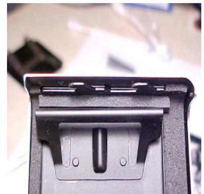
Jetzt ersetzen Sie die Verriegelungsdichtung. Als Sie die alte Dichtung säuberten sahen Sie, das es zwei Flansche (Vorsprünge) gab. Betrachten Sie das Bild weil dieses wichtig ist.
