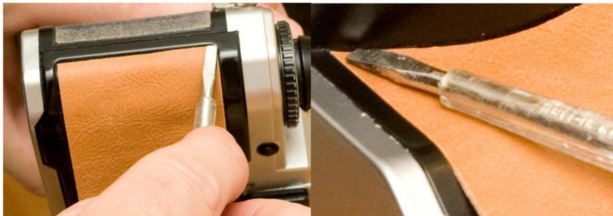
Jetzt erst die oberen und unteren Kanten der Belederung an die Kanten des Kamera Bodys setzen. Wenn Sie das nicht so machen wird die Belederung zu den Kanten überlappen. Wenn Sie die Belederung ans Ende des Kamera Bodys angesetzt haben einfach mit dem Daumen leicht über die Belederung des Bodys nach links und rechts ziehen.
